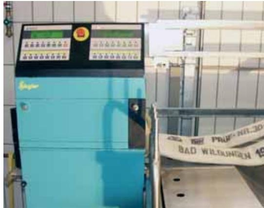
Der Schlauch kann somit nach erneuter Prüfung wieder im Einsatzdienst verwendet werden. Nach dem Prüfvorgang werden die Druckschläuche über die Schlauchaufzugsanlage zum Trocknen in den 26m hohen Feuerwehrturm gehängt.
